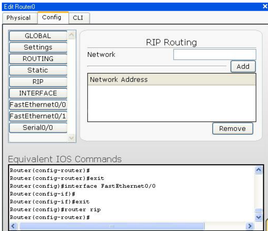
Рисунок 2 – Окно настроек протокола RIP маршрутизатора
