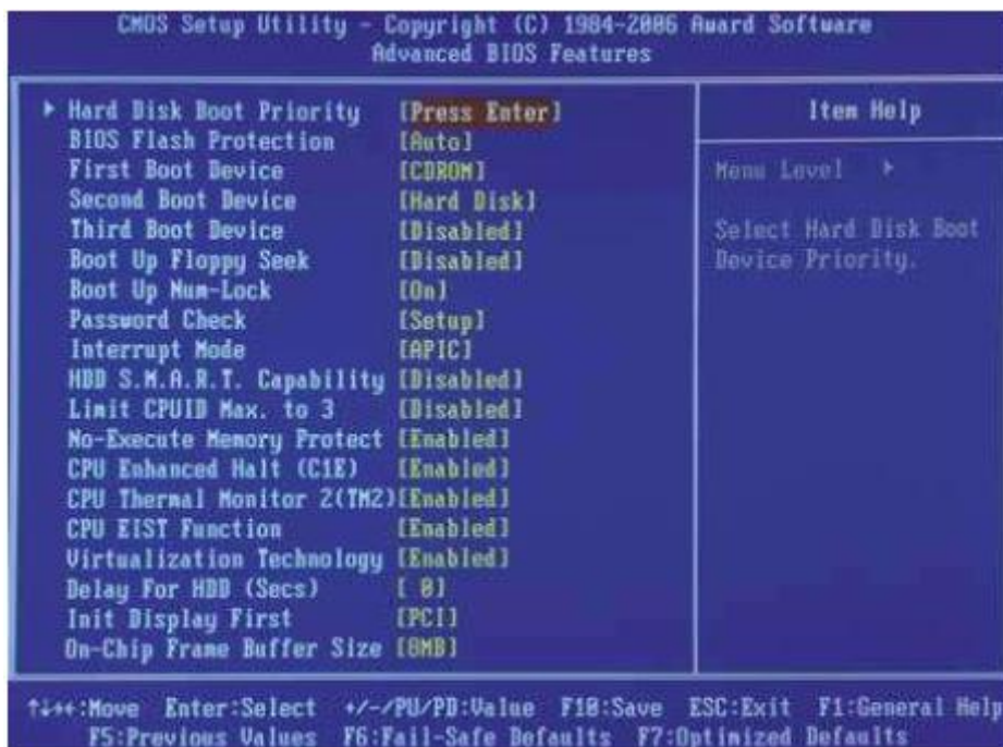
Рис. 4. Меню Advanced BIOS Features утилиты CMOS Setup
