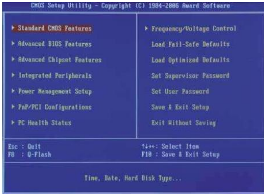
Рис. 2. Графический интерфейс утилиты CMOS Setup Award BIOS
