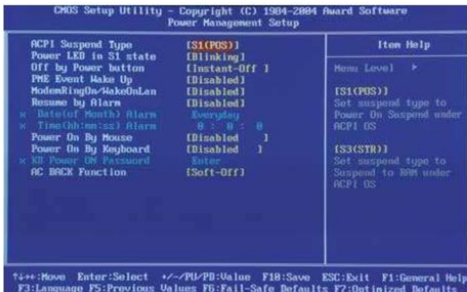
Рис. 8. Меню Power Management Setup утилиты CMOS Setup
