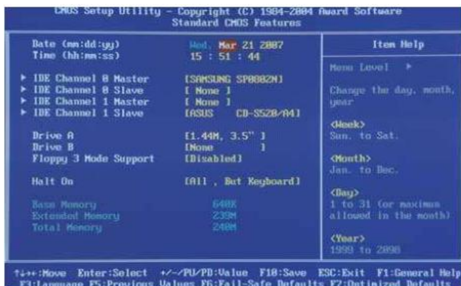
Рис. 3. Меню Standard CMOS Features утилиты CMOS Setup
