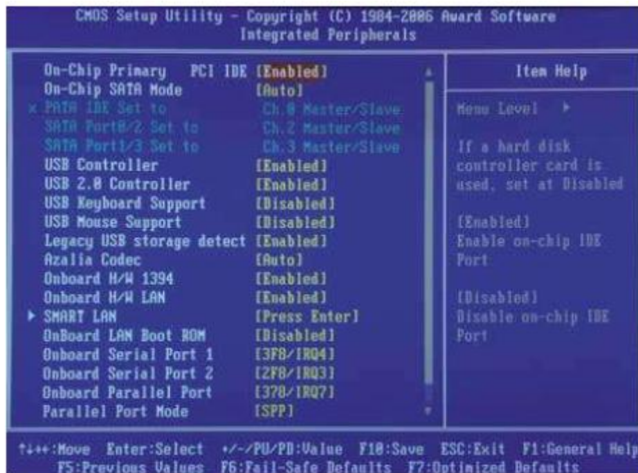
Рис. 7. Меню Integrated Peripherals утилиты CMOS Setup
