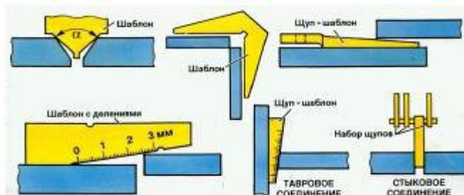
2. Требуется проверить качество сборки конструкции указанной на рисунке. Опишите этот процесс, указав измерительно-контрольные инструменты и их назначение.
